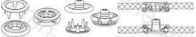
A Part: ring B Part: socket C Part: stud D Part: ring
